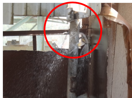
รูปที่ 2-15: ระบบสเปรย์น้ำของโรงโม่
